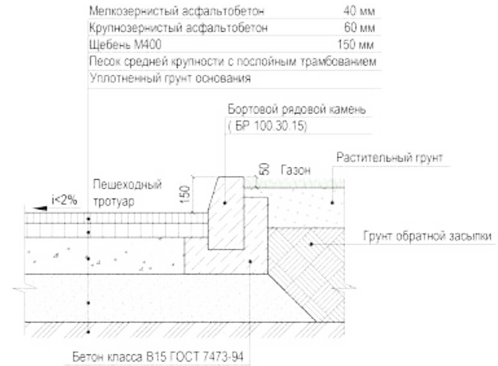
3.13.1 Схема устройства сопряжения асфальтобетонного покрытия и газона
