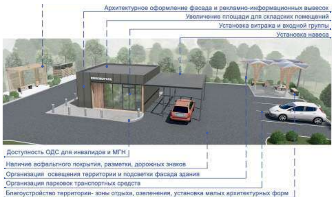
Вариант 2 Пример приведения шиномонтажной мастерской к требованиям Стандарта с расширенным перечнем работ
